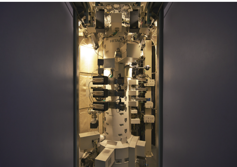
1 MV ホログラフィー電子顕微鏡の前で。この顕微鏡設置に最適な場所として、外村氏が日本中の地質と環境から選び抜いたのがここ、鳩山町だ。非常に硬いとされる岩盤の上に設置されている。
