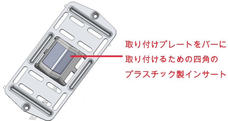
図 19: 取り付けプレートの航空機のバーへの接続
