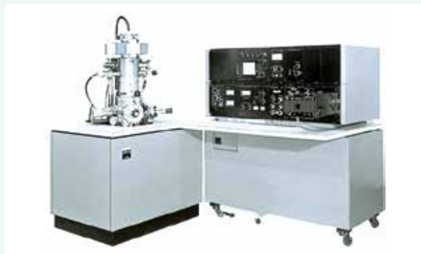
1972年に世界で初めて実用化されたFE-SEM HFS-2形
