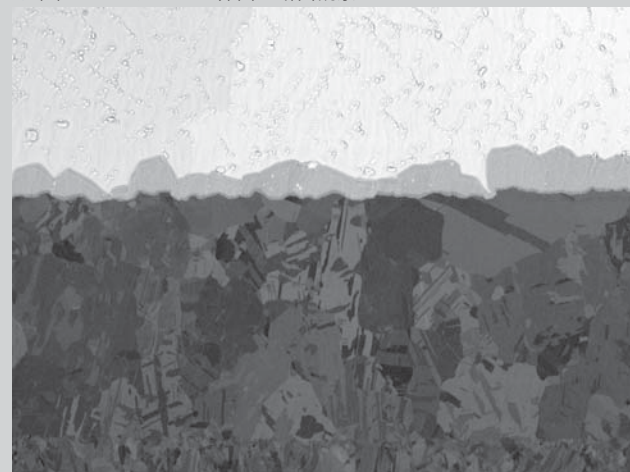
▼(b) Cuメッキ/はんだ界面の断面観察
