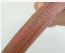
アセチレンガスホースの劣化
