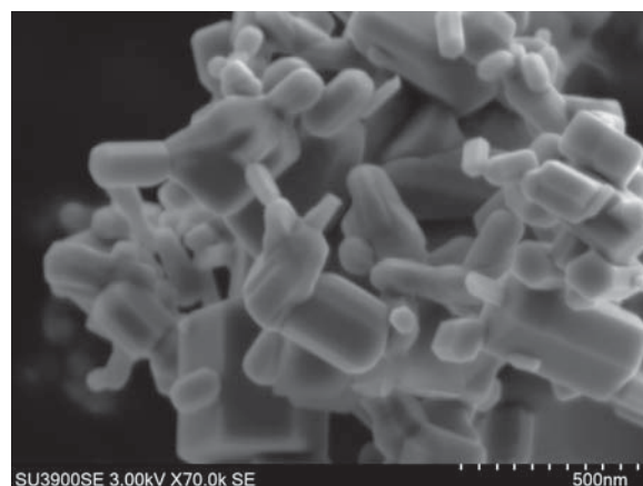
酸化亜鉛粒子 50 nm程度の微小粒子や立体的な形状が確認できます。
