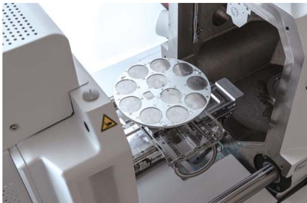
Φ47 mm×11 試料ホルダー搭載例 (SU3900SE)
