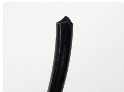
経年劣化により破裂した内部冷却ホース
