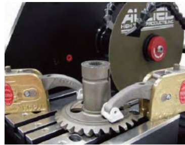
大型サンプルの固定・切断が可能
