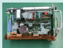
電源基板腐食状況
