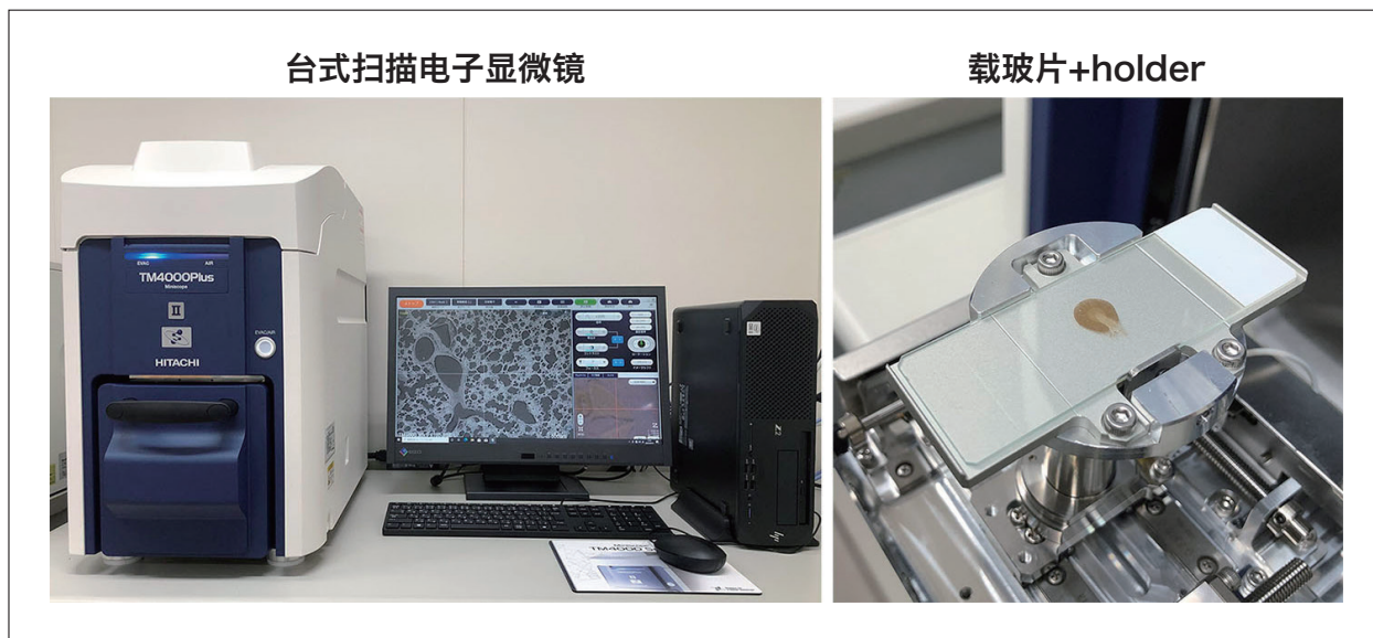
图1 (左图)台式扫描电子显微镜TM4000PlusII外观。(右图)专用的载玻片holder, 装卸方便, 无需进行高度调节。
