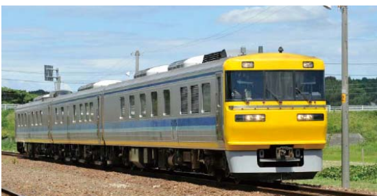
軌道・電気総合試験車 ドクター東海 Comprehensive track and electrical test train Doctor Tokai
