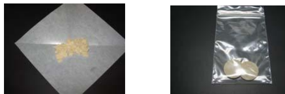
图 2 粉碎后的样品以及加压成形的样品
