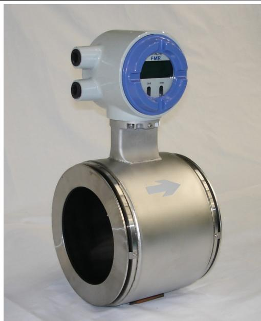
FMR304W形コンパクト電磁流量計は、検出部、変換部一体形で取り扱いが簡単な、はさみ込み式の電磁流量計です。化学、薬品、紙パルプ、バイオ、食品、水処理などの各分野での種々の流量測定に用いられ、容積流量に比例したDC4~20mAの流量信号および流量積算用パルス、または自己診断警報を出力します。
