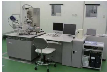
電界放射型走査電子顕微鏡S-4300SE/N ©宇宙航空研究開発機構(JAXA)
