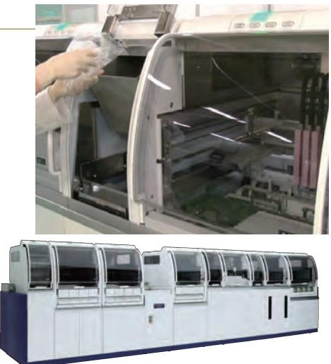
日立ハイテクは、検体検査の前処理と分析処理を自動化・迅速化することにより、診察前検査の実現に貢献します。LABOSPECT TSは、遠心分離、開栓、子分注、バーコード貼付といった前処理の機能をモジュール化し、その組み合わせで検査室の運用に合ったシステムを構築・提供します。LABOSPECTシリーズはユーザーのニーズを取り入れ、より一層進化していきます。
