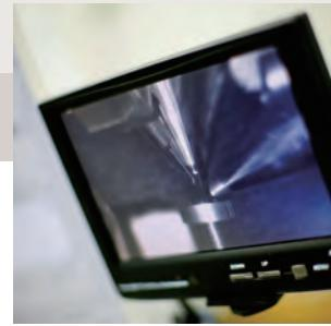
試料室(真空状態)の室内確認用LCD
