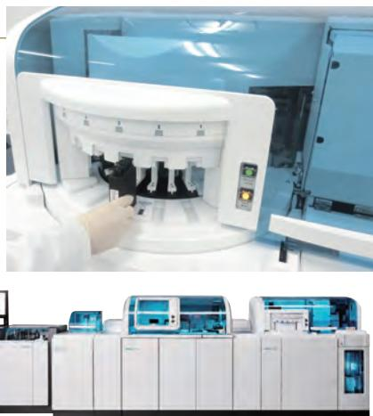
「24時間必要なときにいつでも検査を」のニーズに応えます。分析中、装置自身が自動でメンテナンスをする機能を新たに搭載し、ユーザーの手間とメンテナンスにより検査がストップする時間を大幅に削減しました。また、検体プローブを超音波洗浄することでISE、生化学(c503)、免疫(e801)の各モジュール間の分析順序をよりフレキシブルにし、迅速かつ正確に検査データを提供します。cobas pro® integrated solutionsは、世界の臨床検査の現場で活躍しています。
