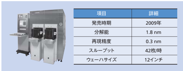
図4 | CG4100形 測長SEMの外観と主な仕様 32 nmプロセス量産および22 nmプロセス開発に対応し、最先端ダブルパターニング世代の計測ニーズに応える高スループット機である。
