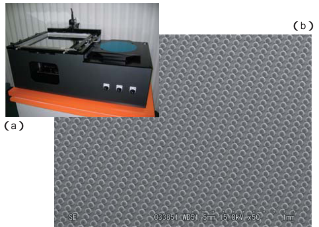
12インチ対応手動マウンタ a と、直径60 μm/ピッチ100 μmのバンプ外観 b ) ( ウェーハ提供: 株式会社日立超LSIシステムズ )
