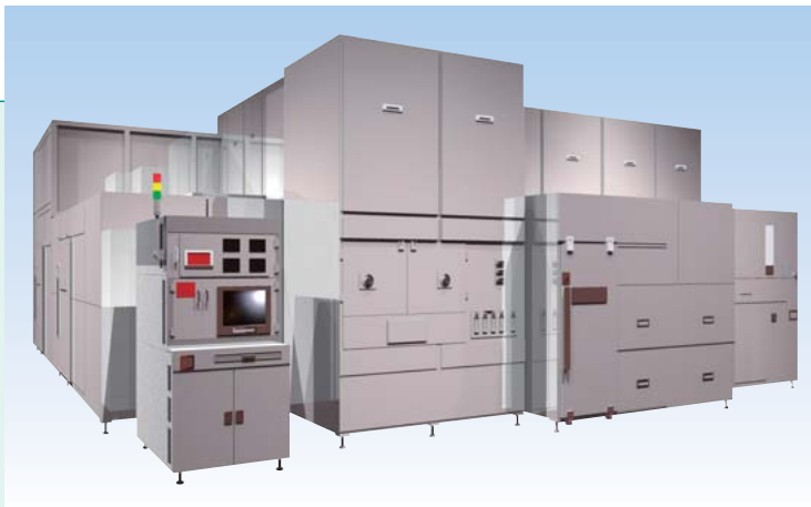
第8世代液晶用大型ガラス基板露光装置(縦・横12m,高さ4.5m)
