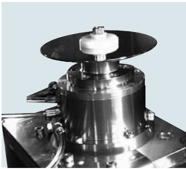
図13 スピンドルモータ 回転非繰り返し振れがサブナノメートルレベルの静圧気体軸受である。
