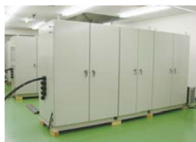
PCBモニタ装置CP-2000Pの外観。手前のホースで検査場所から気体を取り込んで計測します。
