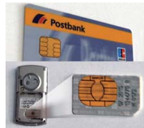
安装于IC卡和手机内的IC芯片
