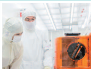
このカセットにウェーハをセットすると、それぞれのプロセスレシピに設定された加工が施されます。
