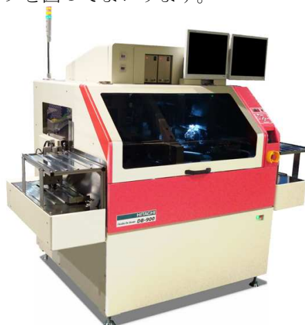
日立ハイテクインスツルメンツ製高速ダイボンダ「DB-900」
