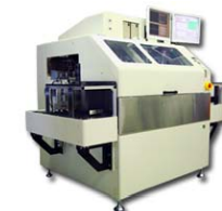
新型フレキシブル ダイボンダDB900
