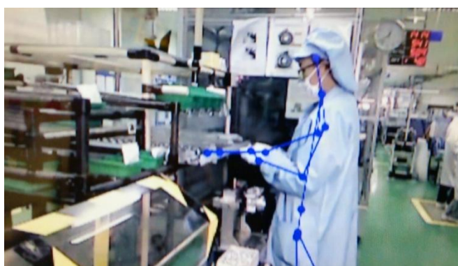
図2:映像解析技術を活用した作業のモニタリング
