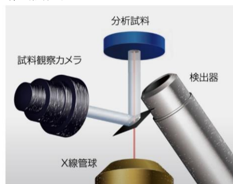
【試料観察と照射 X 線の同軸光学系の構造図】
