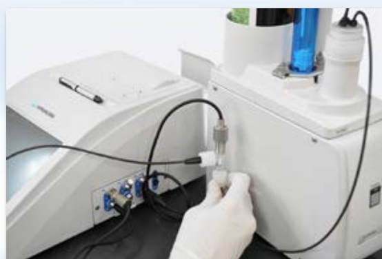
滴定液温度測定センサ図
