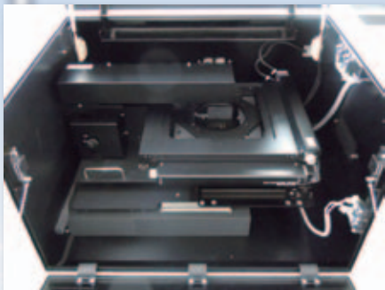
自動XYステージ付5°反射/透過測定システム 5 Degrees Reflectance / Transmittance Measurement System with Automatic XY Stage
