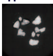
Specimen : Mineral Signal : BSE Magnification : 15x Number of images : 54images (18x3)
