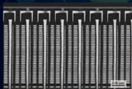
3D NAND デバイス 断面SEM像 3D NAND device cross-section SEM image
