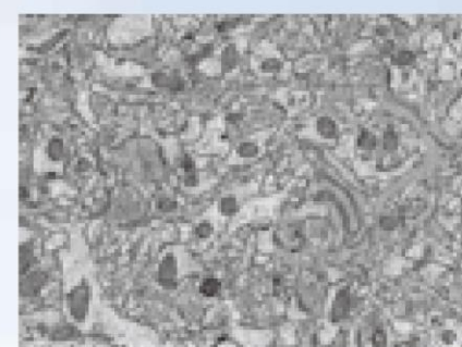
低加速反射電子像 試料：マウス脳細胞切片 加速電圧：2 kV 倍率：20 kX 検出器：MD
