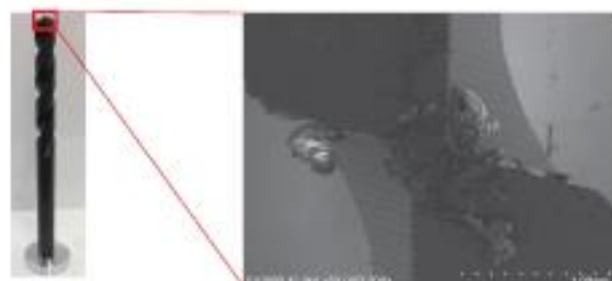
ドリル工具 (高さ130 mmH) 装着例 ドリル工具先端部 (分析最適位置WD=10 mm)
