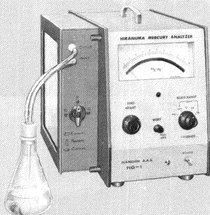
図6 HG-1形平沼水銀濃度計
