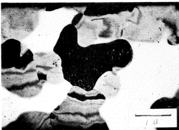
第 4-6 図 第 3、4、5 図と同一試料異視野 300°C 結晶成長が、かなり進んでいる。
