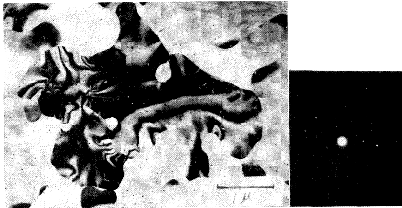
第 4-5 図 銅アルミ蒸着膜の熱変化過程（同一視野連続撮影）450°C
