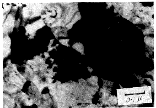
第 4-7 図 第 3、4、5 図と同一試料異視野 300°C この視野では Moiré 模様が見られる。
