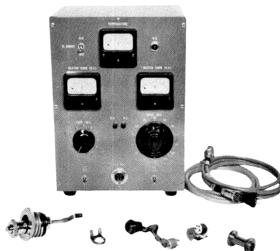
第1図 日立 XMA-4 用加熱装置アタッチメント
