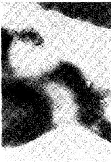
第4図 アルミニウム薄膜の傾斜による電子顕微鏡像 中央：傾斜角 0^\circ 周辺：傾斜角 3^\circ 方位角 (a) 0^\circ (b) 90^\circ (c) 180^\circ (d) 270^\circ 加速電圧 75 kV
