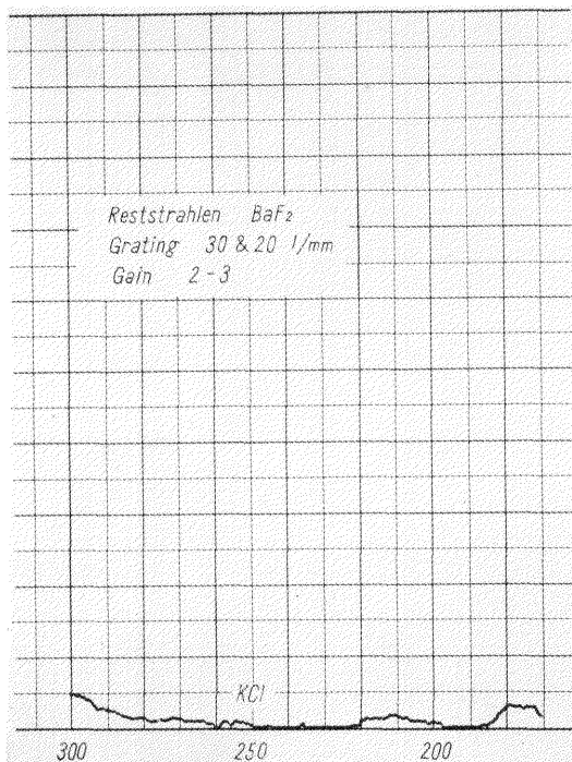
第2図(c) FIS-1形 遠赤外分光々度計の迷光 その3 BaF 2 領域
