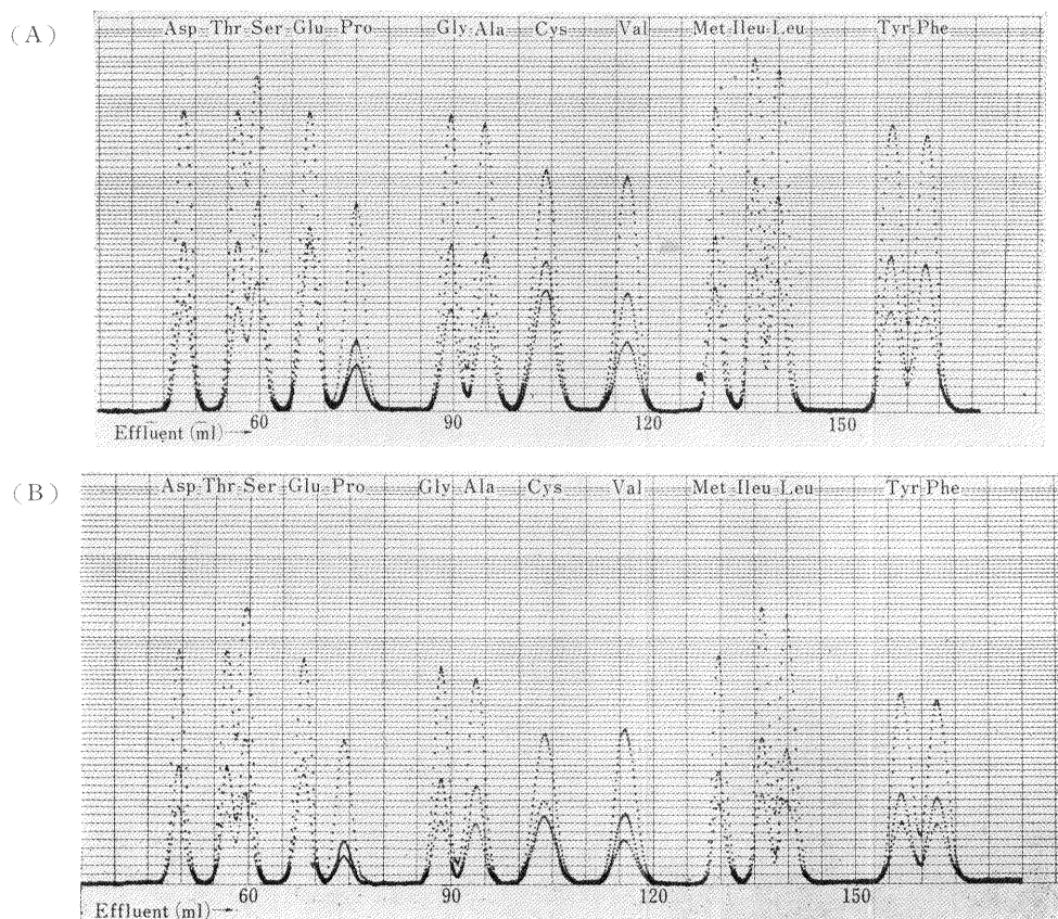
第1図 50 cm カラムによる中性・酸性アミノ酸標準試料の分析
