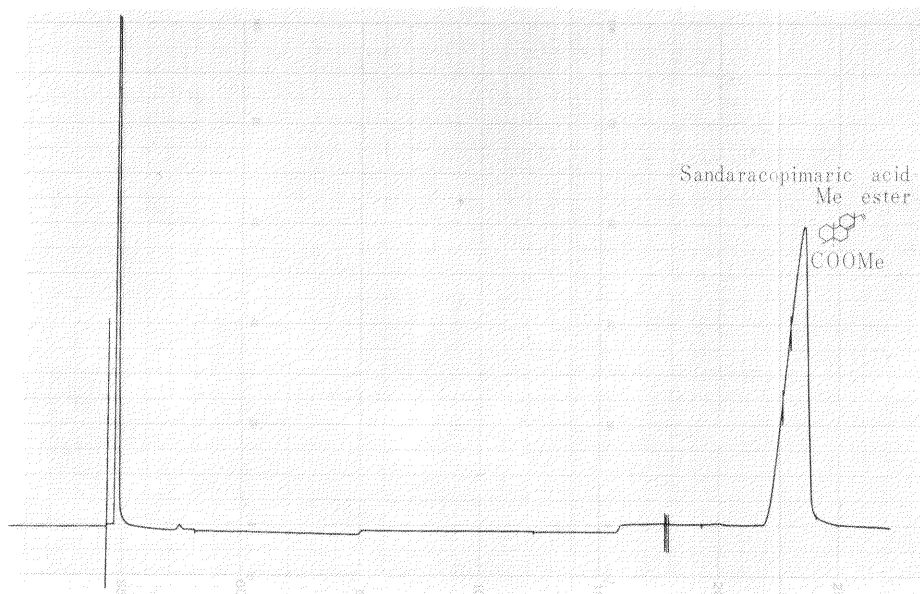
第2図 サンダラコピマル酸メチルエステルのガスクロマトグラフィーのピーク
