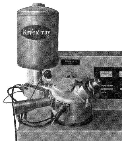
図3 SSM-2形SEMに取付けた半導体検出器
