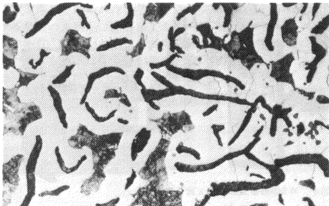
図4 (A) 真空中で1,050分加熱後の顕微鏡組織 950~600°C熱サイクル
