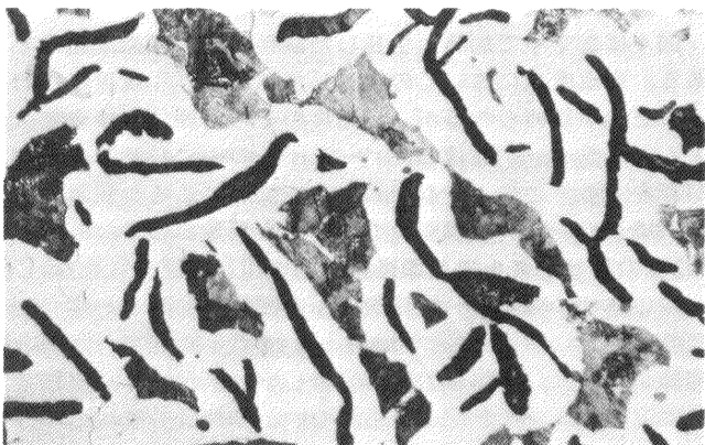
図4 (B) 真空中で1,050分加熱後の顕微鏡組織 950~800°C熱サイクル
