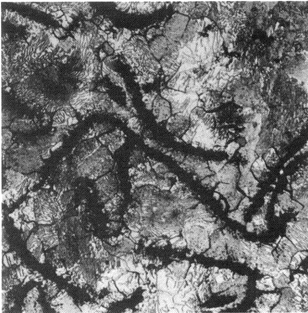
図13 CO中で 950°C 1,050分 恒温加熱後の顕微鏡組織
