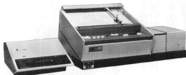
キーボード付属装置を装着した340形日立自記分光光度計
