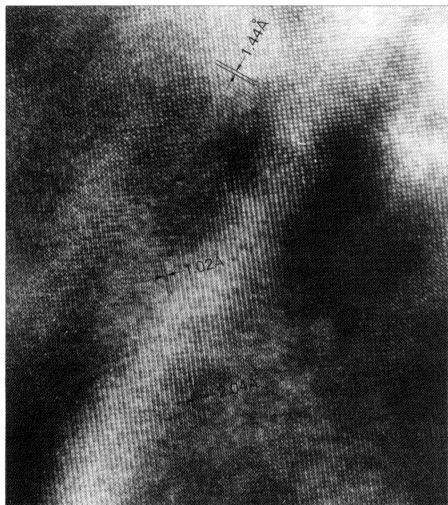
図3 高分解能写真 試料：金(2.04Å ½格子間隔)の結晶格子(200)
