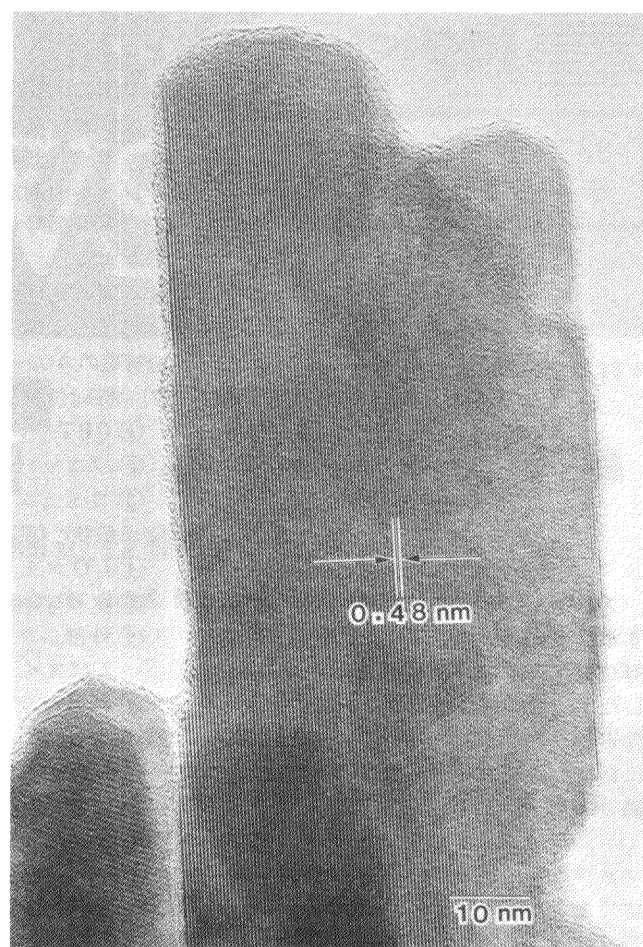
図17 \gamma - \text{Fe}_2\text{O}_3 超微粒子の高分解能像（格子像）
