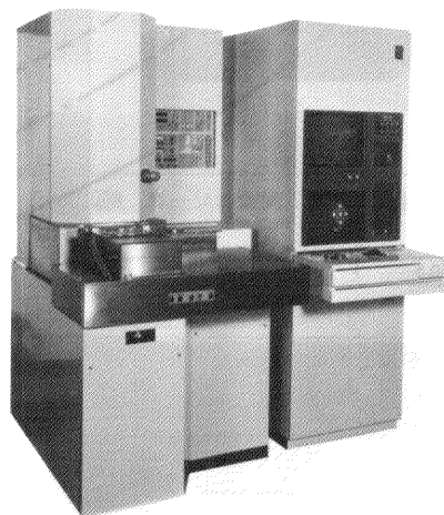
図1 S-6000形日立FEB測長装置
