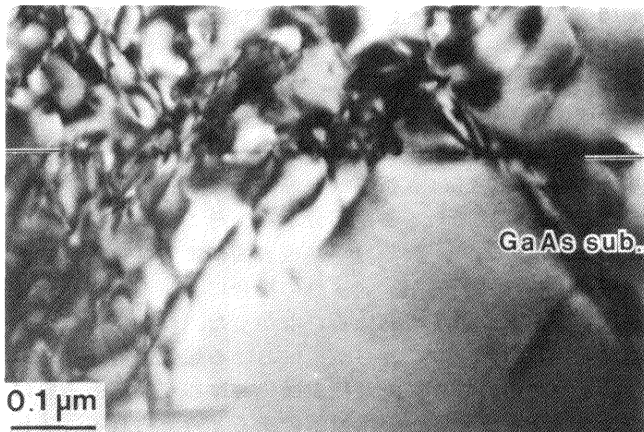
図9 GaAs基板と成長膜の界面における転位
