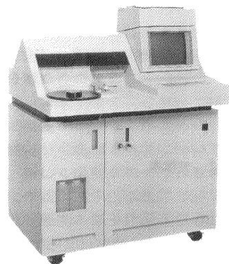
図1 Z-9000形日立多元素同時分析原子吸光分光光度計
