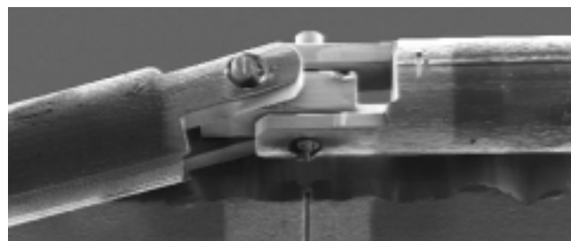
図8 FIB加工とマイクロサンプリング機能を駆使して製作したマイクロユニバーサルジョイント
