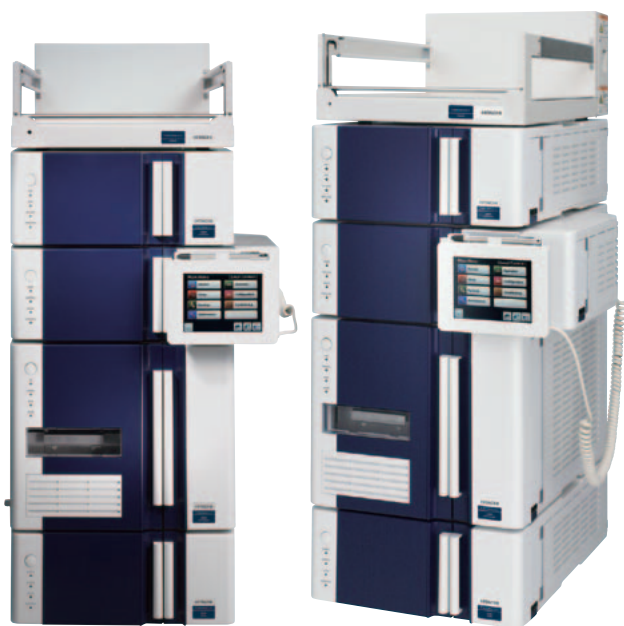
図1 日立高速液体クロマトグラフChromaster5000シリーズ外観
