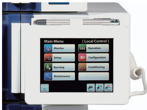
図4 タッチパネル付きGraphical User Interface(GUIコントローラ)
