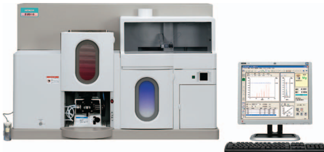
図1 Z-2010形偏光ゼーマン原子吸光度計
