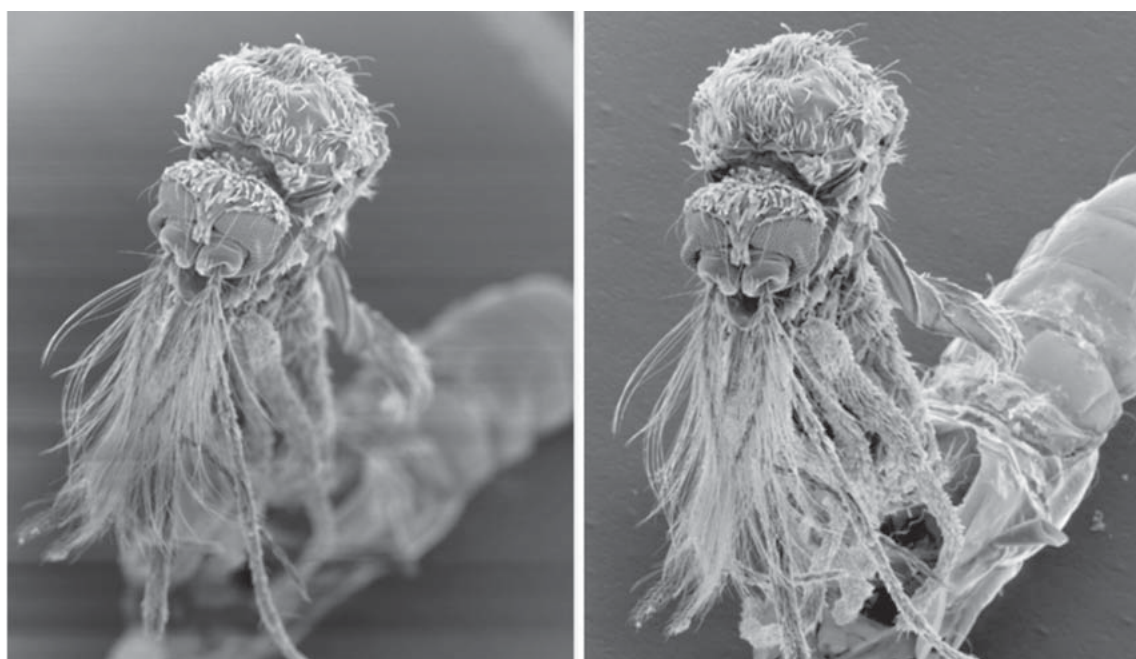
図21 焦点深度の差によるSEM像の比較 左：WD15 mm，絞り大，では焦点深度が浅く焦点位置以外のぼけが大きい。 右：WD30 mm，絞り小，では焦点深度が深く全体に焦点が大きくずれない。
