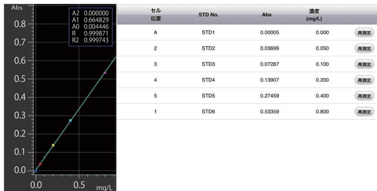
図7 6価クロムの検量線と濃度測定結果
