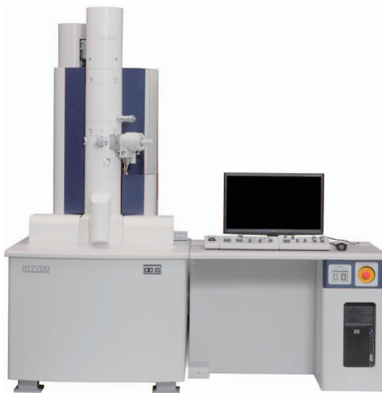
図1 HT7700鏡体部の外観(OPTIOのSTEM検出器を搭載)
